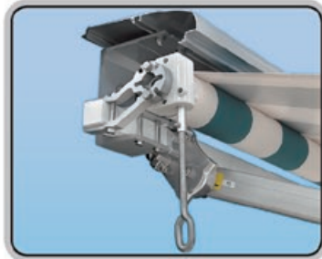
■手動ギア (PAT.P) テンパル独自の逆転防止機構を標準装備。キャンバス破損の心配がありません。フリーセッティングにより装着も簡単。ギア比15:1で耐久性も向上、巻き上げ力も30%軽減(当社比)しました。
