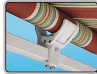
■巻取サポート (PAT.P) ※巻取サポートはポリエステル系キャンバス使用時での設定を推奨します。 2ピース構造の採用により、取付取外し及びメンテナンスも容易です。抜け出し防止の形状で巻取パイプのたわみ・はずれを防止します。回転ベルトのガイドにより、キャンバスの耐久性を高めています。
