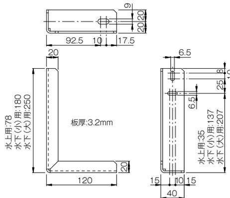
※ 製品を構造体へ取り付ける締結ねじ類 (M6) は付属されていません。
