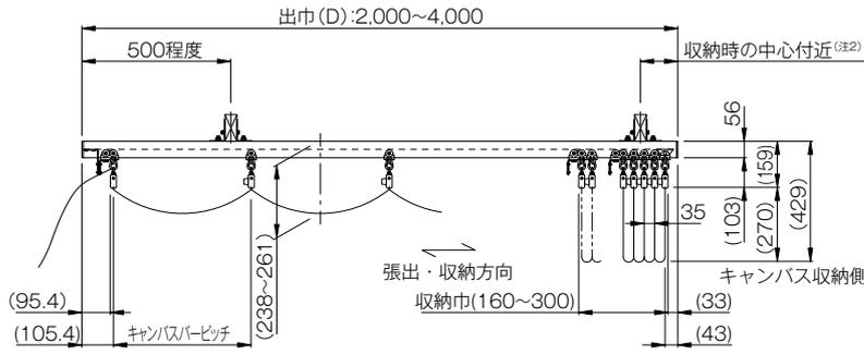
(注 1) 出巾 (D) 4,001mm 以上からレール結合となります。レール切断寸法は、1,000mm (最小) ~ 4,000mm (最大) となります。レールの長い方をキャンバス収納側に設定して下さい。レール結合位置は、レール切断寸法と現場躯体状況に合わせて決めて下さい。
