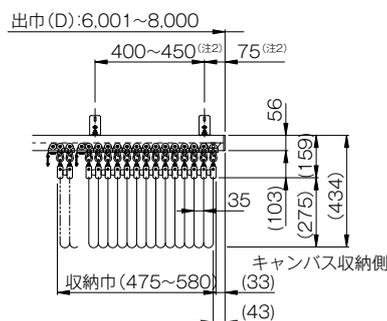
(注 1) 出巾 (D) 4,001mm 以上からレール結合となります。レール切断寸法は、1,000mm (最低) ~ 4,000mm (最大) となります。レールの長い方をキャンバス収納側に設定して下さい。レール結合位置は、レール切断寸法と現場躯体状況に合わせて決めて下さい。
