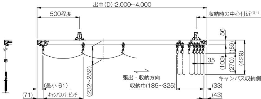
(注 1) 指示位置に設置出来ない場合は、取付ブラケット追加や別途金物等でレールを補強して下さい。0.56kg/m以上のキャンバスを使用する場合、規格間口又は規格出巾によっては取付ブラケットを追加する必要があります。
