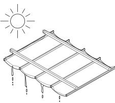
雨や雪、結露などの水分が凍結した場合、解けるまで操作しないで下さい。キャンバス破損の原因となります。
