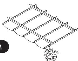
キャンバスの開閉を妨げたり、本体破損の原因となったり、重量増加により落下事故につながります。
